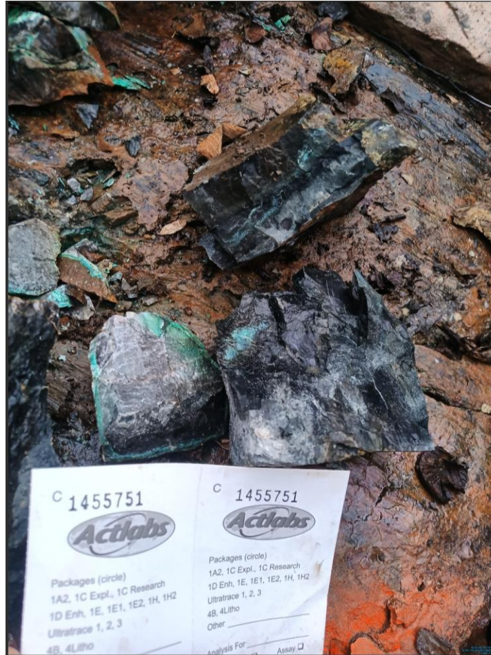
▲ #C1455751 : Mudstone chertueux, minéralisé en malachite (2 %) en auréole et dans les jointures du litage. Résultats en attente.
