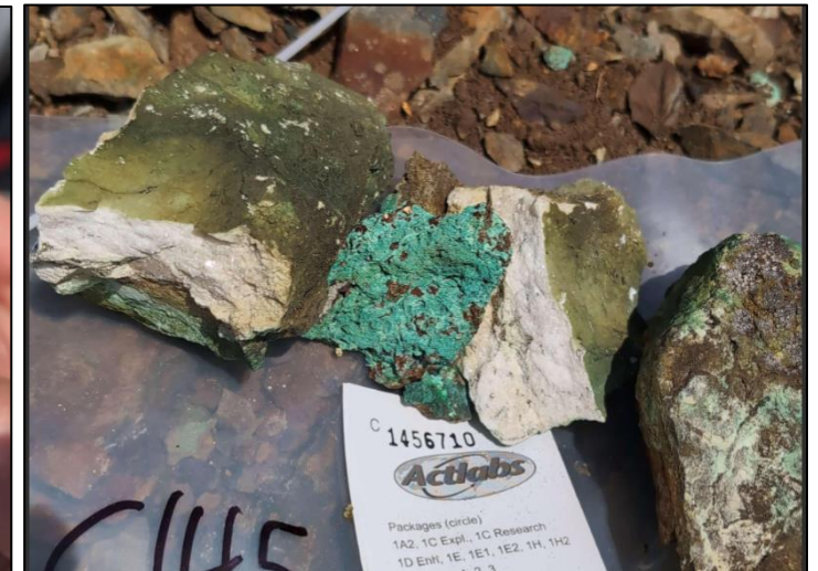
▲ #C1456710 : 12,30 % Cu, 0,36 g/t Au, 0,57 % ETR, 0,02 % Co, 6,60 g/t Ag Veine de calcite et malachite
